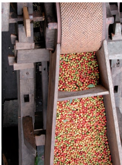
Extraction des grains de café de leur enveloppe
